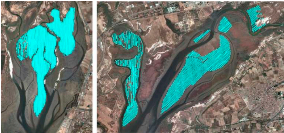
Fig. 19. Con trazos en color se muestran las pasadas realizadas por los aviones en tratamientos antilárvicos (Bti), obtenidas por los equipos DGPS en las marismas del Odiel (izqda.), y marismas del Tinto (dcha.).
